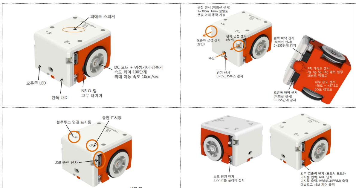
[그림 IV-4] 교육용 로봇인 햄스터 로봇의 구조와 기능
