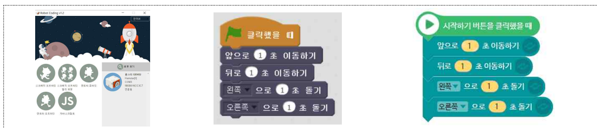
[그림 IV-10] 햄스터 로봇의 엔트리와 스크래치 명령 블록 예시
