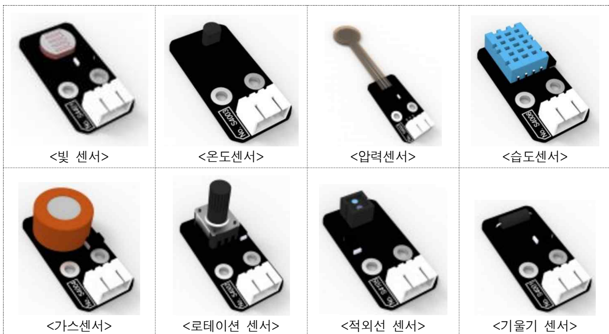
[그림 IV-8] 로봇 및 피지컬 컴퓨팅에 사용할 수 있는 센서 모듈 예시
